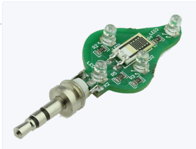
Figuur 4a. De 'vlamprint'; de LED's, sensor en klinkstekker zijn gemonteerd.
