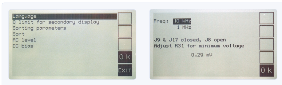
Figuur 16. Twee screenshots van het kalibratiemenu, waarvan we in het tweede deel van dit artikel de vele subtiele opties zullen ontdekken. De eenvoud van de kalibratie is een van de belangrijkste troeven.
