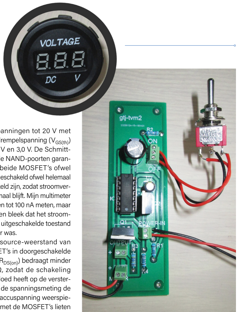
Figuur 2. De uiteindelijke schakeling op een 'echte' print, met de on/off/on momentschakelaar en de voltmeter (voor paneelmontage).
