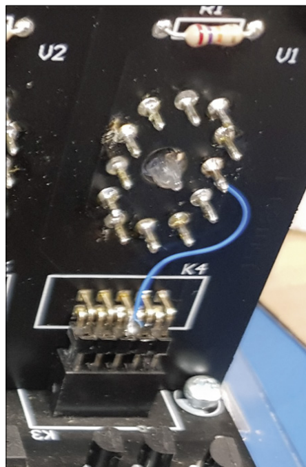
Figuur 4. Aansluiting van het '3'-element van Nixie-buis V1 op de middelste pen bovenop K4 (wijziging geldt alleen voor bestaande printen).
