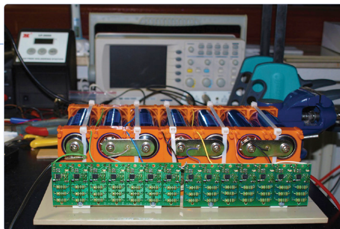
Figuur 7. LiFePo-batterij met balancer van de Segway-kloon van de auteur.
