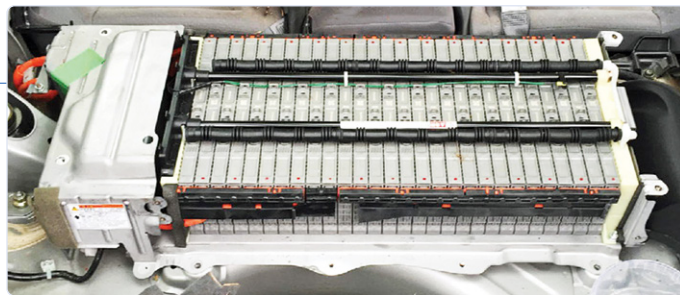
Figuur 2. De accu van de voormalige Prius II van de auteur. U ziet 28 pakketten van elk 6 cellen, goed voor een nominale spanning van 201,6 V.
