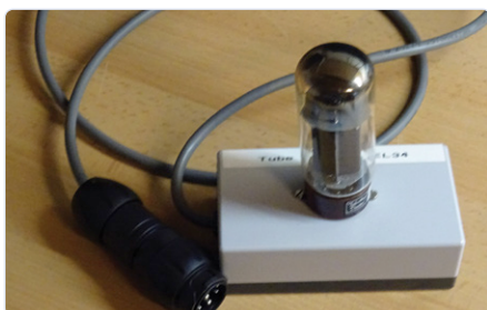
Figuur 14. Buisadapter voor een EL34.
